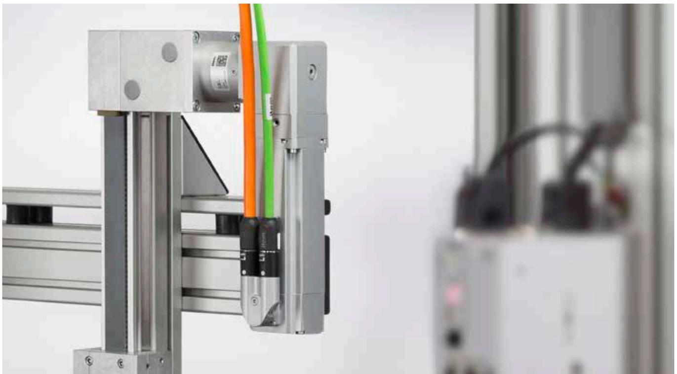
Fig.: Unità lineare KRF 8 80x40 ZR (art. n. 0.0.641.21), riduttore WP 60-3 (art. n. 0.0.666.14), motore SE 60 (art. n. 0.0.666.02)
