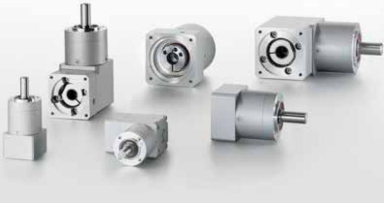
I riduttori AP collegano assialmente un motore a un set di azionamento. I riduttori epicicloidali sono compatti, non richiedono manutenzione e sono disponibili con tre diversi rapporti di trasmissione fissi: 1:3, 1:5 e 1:7.
