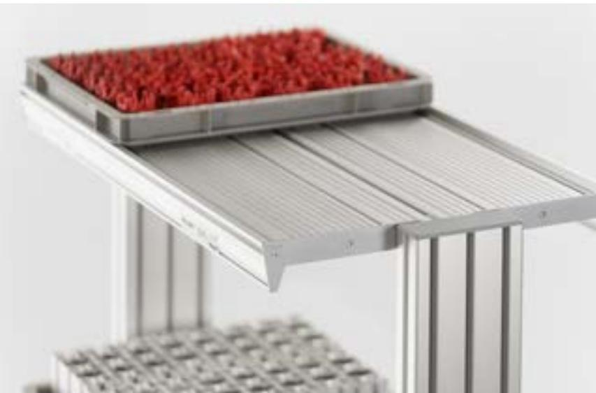
Basta agganciare il profilato di predisposizione dei materiali 8 180x50 in una scanalatura 8 orizzontale per creare rapidamente una superficie per i contenitori per la predisposizione dei materiali. Raddoppiando in modo simmetrico il profilato di predisposizione dei materiali accanto a un profilato 8 40x40 si otterrà una superficie di appoggio per contenitori Euro (400 mm) con bordo perimetrale.
