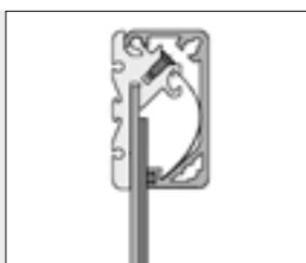
Nelle intelaiature di supporto portadocumenti chiuse universali può essere introdotto un pannello di protezione che viene fissato attraverso il profilato coperchio.
