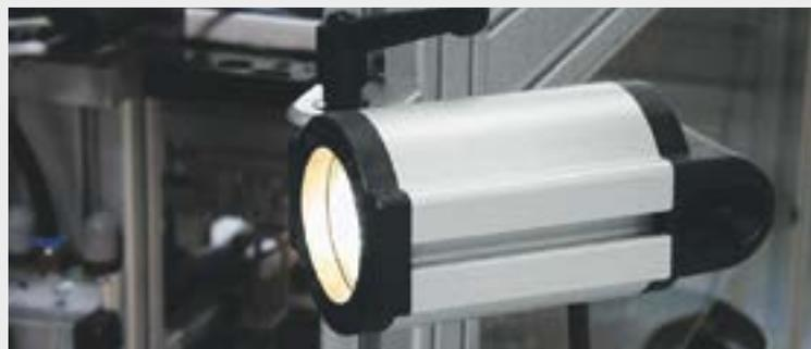
Faro 35W fissato con leva di bloccaggio e regolabile con lo snodo 8 40x40.
